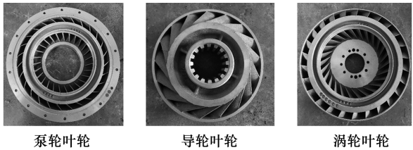
图 6 YJ280 液力变矩器的叶轮
