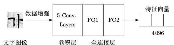
图 4 简化后的 AlexNet 卷积网络对文字图像进行特征提取的示意图
