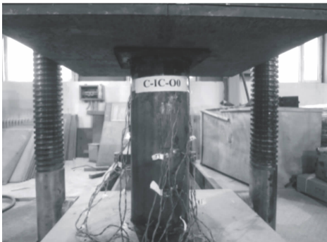
图 4 加载与采集装置
