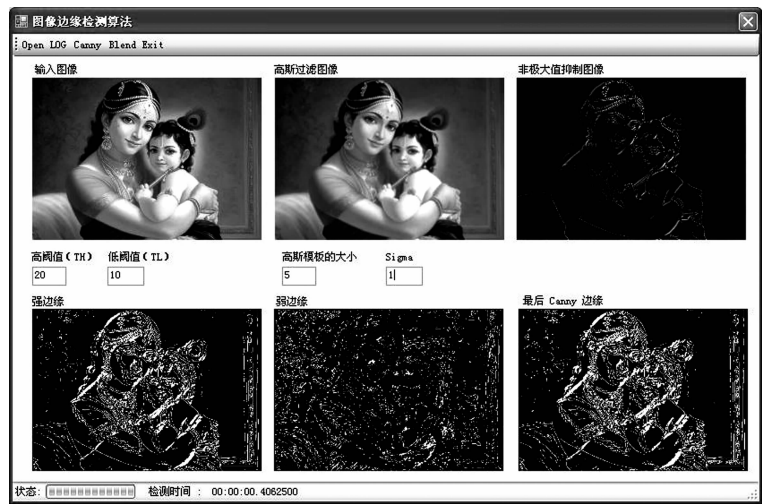
图 1 Canny 算子双阈值边缘检测实例
